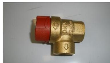
**Prescor 1/2" x1/2" (внутр.резьба), клапан предохранительный, Pсраб=3.0бар, Tмаx=130C**
